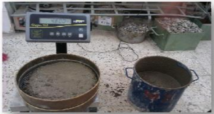
Figure I.11 : Essai de la stabilité au tamis.
