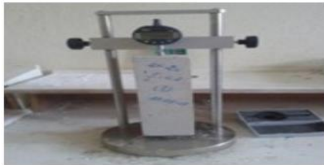
Figure I.14 : Appareil de mesure de retrait « Réfractomètre ».
