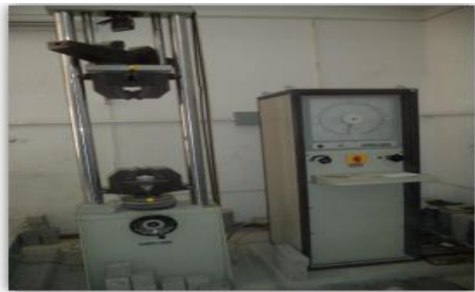
Figure 1.13: Mesure de la résistance à la traction par flexion
